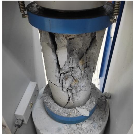
Gambar 2. Pengujian Kuat Tekan Beton
