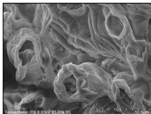
Gambar 5. Hasil Foto SEM Permukaan Tongkol Jagung mula-mula
