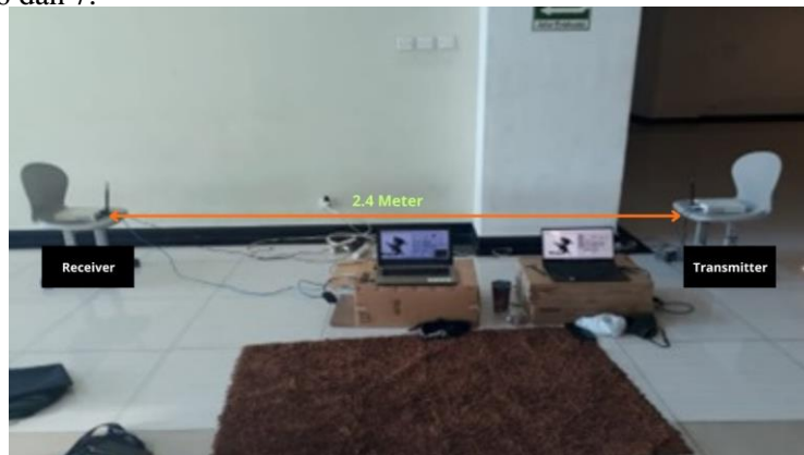
Gambar 6. Konfigurasi pengukuran pada kondisi LOS
